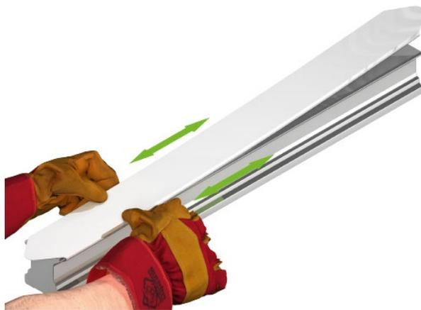
**B1. Fixer la bande de recouvrement (uniquement pour bande de recouvrement > 4000 mm)**
