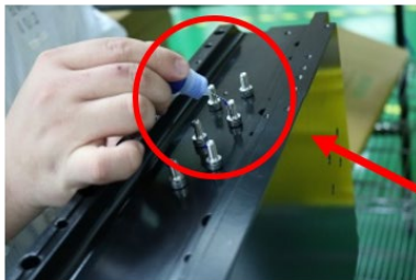
5. ábra15: Használjon nem mágneses szerszámot az állórész beszereléséhez
