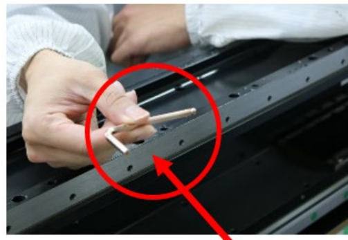
5. ábra15: Használjon nem mágneses szerszámot az állórész beszereléséhez
