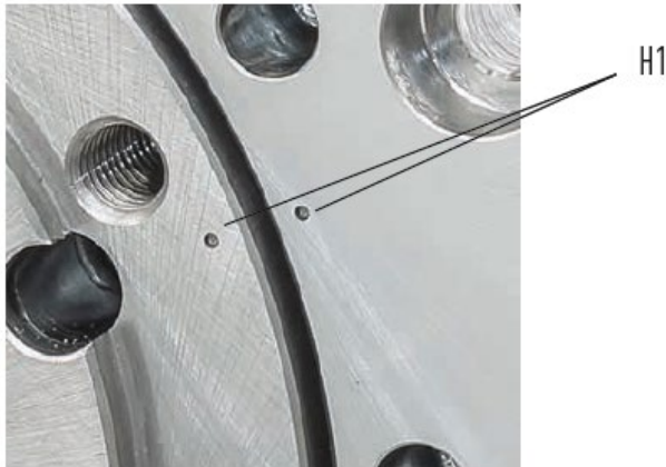
Fig. 5.4 : Marquage d'index pour le capteur de position
